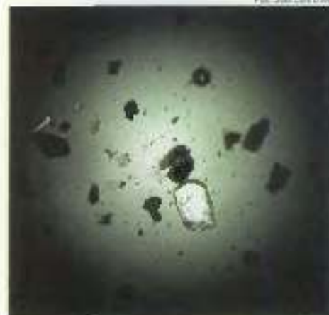
Figura 1 - Microscopia de luz polarizada, 100 X. Área do fragmento de policromia azul clara mostrando a presença de branco de chumbo.
