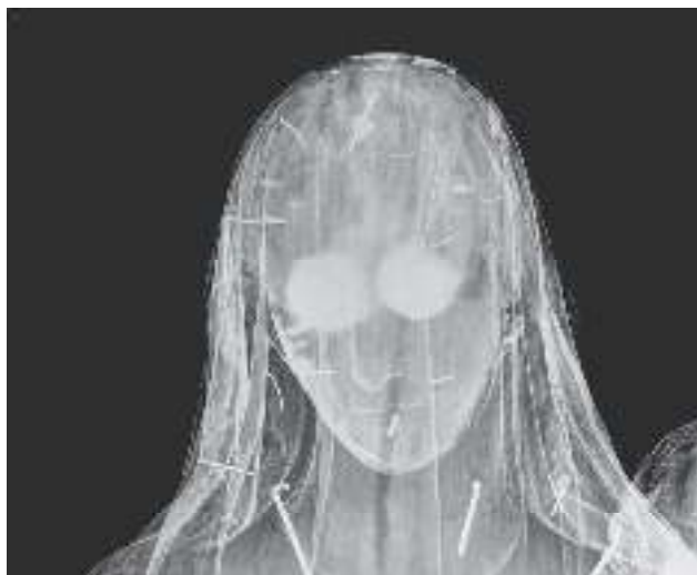
Figura 6 – Imagem de madeira policromada e dourada de Nossa Senhora do Patrocínio – atacada por termitas e com intervenções inadequadas.
